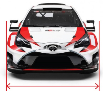
เส้นสีแดง เป็นขอบเขตส่วนที่กว้างที่สุดของแท่งข้างรถคันนี้ ห้ามมีอุปกรณ์อากาศพลศาสตร์ใดๆในด้านหน้ายื่นเลยเส้นสีแดงนี้
